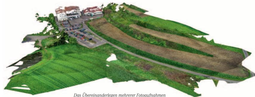
Das Übereinanderlegen mehrerer Fotoaufnahmen erzeugt ein dreidimensionales Abbild des Geländes
